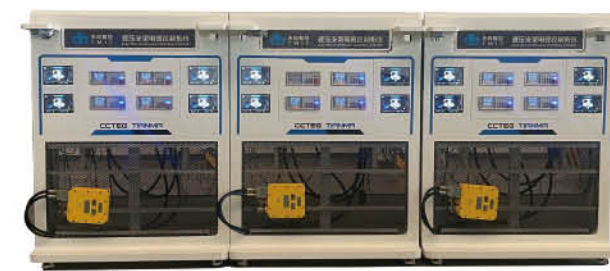
液压支架电液控制系统
